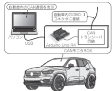
図1 実際のクルマのCAN通信モニター実験 CAN通信が完了した状態でArduino Uno R4を使用し、実際の自動車の高電圧ネットワークをモニタリングしている。
