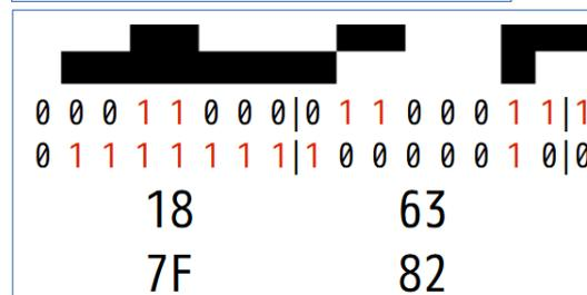
モノクロサポートを持つマシンがカラーも同時にサポートする場合、「モノクロ 1bpp の同様の 1ドット=1ビットのVRAMを複数枚持つ」という「複数VRAMプレーン構成」とすることが多く、IBM-PCのVGAやLUNAもこの形式を採用していました。（これを planar VRAM と呼ぶようです）
